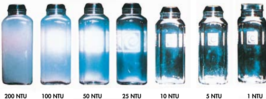
Experiencia que visualiza la turbidez del agua de 1 a 200 NTU. La filtración mediante Filtr-Cleer reduce la turbidez por debajo de 5 NTU y el OFSY por debajo de 0,5 NTU.
